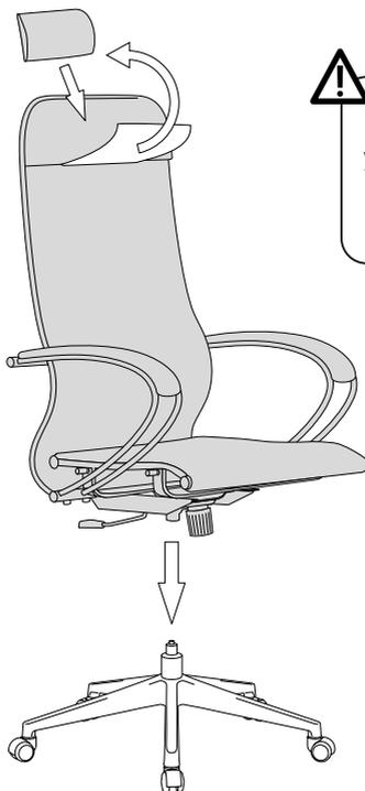
⚠ Для долгой и исправной работы газ-лифта после установки необходимо при помощи механизма поднять и опустить кресло в крайнее положение не менее 5 раз.
